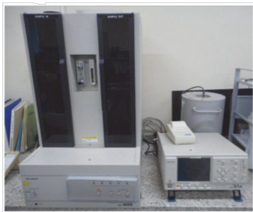
図4 Ra-226の測定機器( \alpha 線測定装置)
