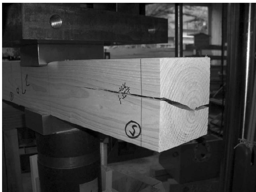
第13図 めり込み試験において内部割れが進展した例
