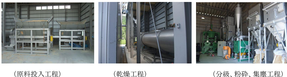
図.V-58 高規格木粉製造ライン
