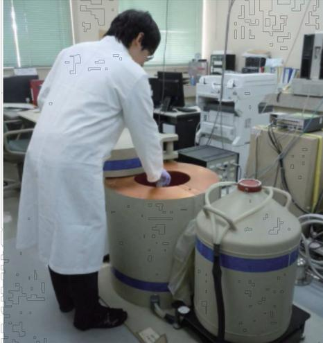
写真2：ゲルマニウム半導体検出器での測定の様子
