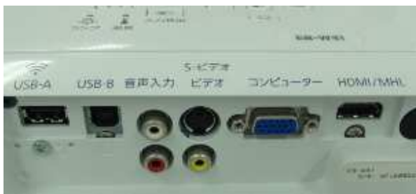
(例) プロジェクターの接続端子
