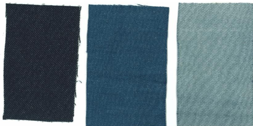
処理前 劣化抑制条件での脱色 開発した脱色条件 次亜塩素酸ナトリウム処理によるストレッチデニムの脱色の様子
