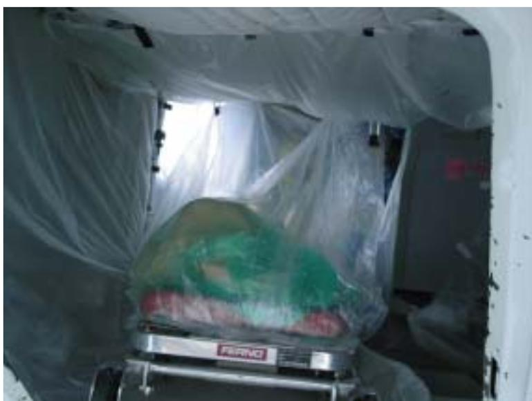
写真 ヘリコプター内壁の防護状態と、ストレッチャー上の患者が天幕よりのビニールにより2重に被覆されている状態
