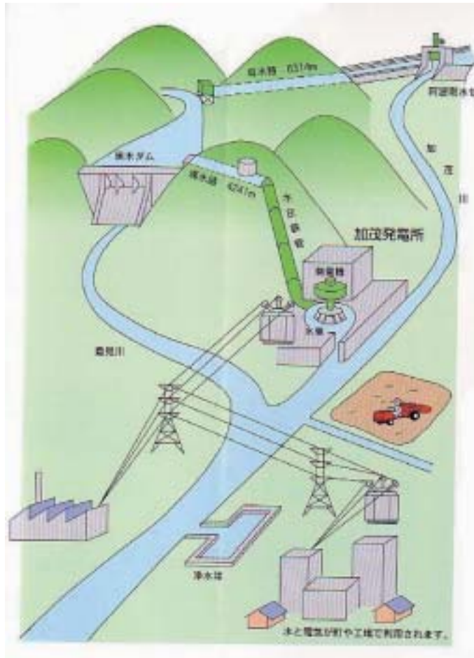
黒木ダムと発電の仕組み
