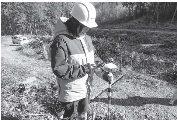
GNSS測量の様子
