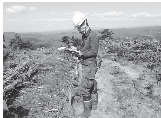
GNS S測量機を活用した周囲測量
