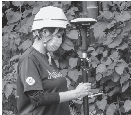
GNSS測量機による周囲測量
