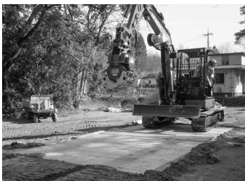
バックホウによる走行摩耗試験
