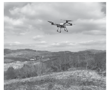
〔 写真：コンテナ苗運搬状況（約9kg） 林業用ドローン最大運搬重量 約15kg 〕
