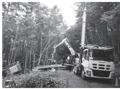
大型トラックをベースとしたコンラッド社製のタワーヤーダと架線用搬器
