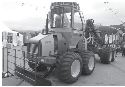
最大時速22km、最大積載量5tを誇るノボトニーエンジニアリングワークス社製の8輪駆動フォワーダ
