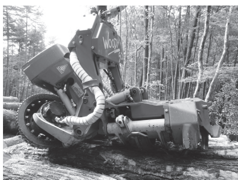
針葉樹・広葉樹及び曲がり材の造材を高效率化できるコンラッド社製ハーベスタ
