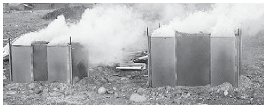
簡単スミヤケール・ミニミニW (左) 簡単スミヤケールW (右)
