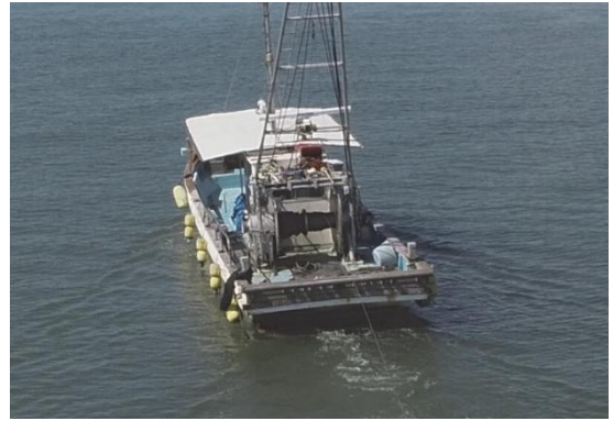
漁船による海底耕うん作業の様子
