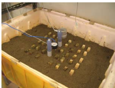
木材腐朽促進試験
