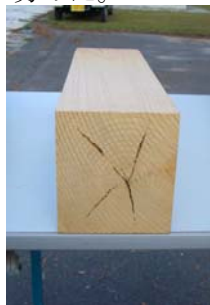
既存の高温乾燥による仕上がり (変色し、内部割れが発生する)
