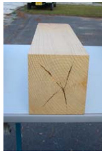
高温乾燥による仕上がり (内部割れが発生する)
