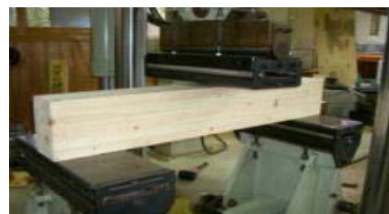
台形集成材の実大せん断試験
