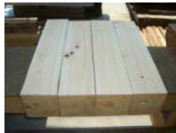
開発した複合乾燥による仕上がり (変色や内部割れが少ない)
