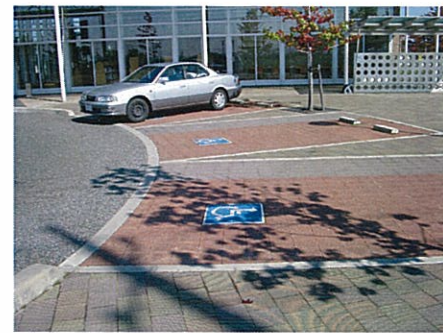
玄関近くに設けられた車椅子用駐車スペース 車道を横断することなく玄関へアプローチ。
