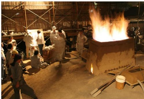
中世たたら製鉄の再現（新見市）
