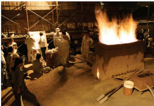
中世たたら製鉄の再現（新見市）
