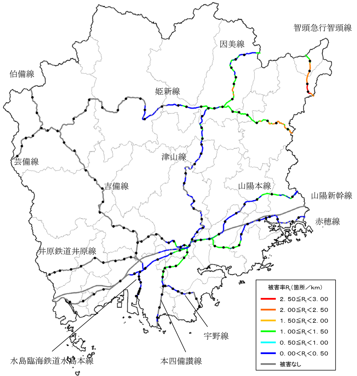
図 3.6.2 鉄道施設被害
