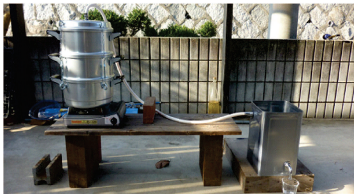
蒸留装置 (全景)
