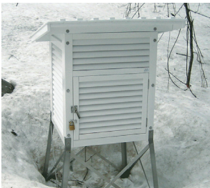
現地百葉箱(中にRPLD素子を設置している)
