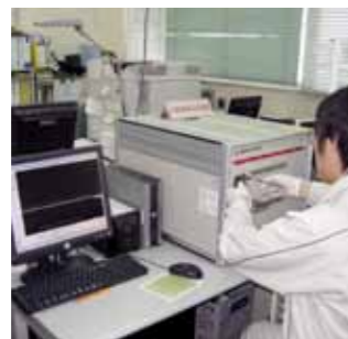
ウランを測定する アルファ線スペクトロメータ
