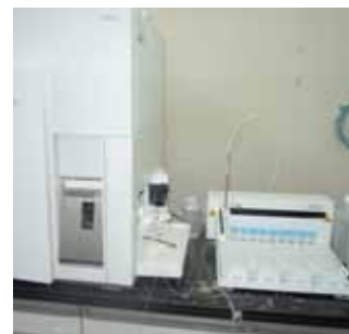
ウランを測定する 高周波誘導結合プラズマ質量分析装置 (ICP-MS)
