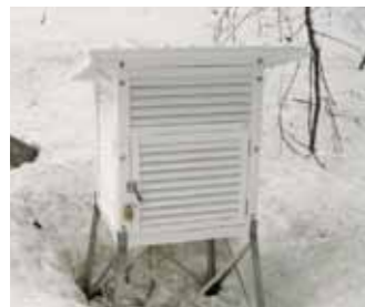
現地百葉箱 (中に RPLD 素子を設置している)
