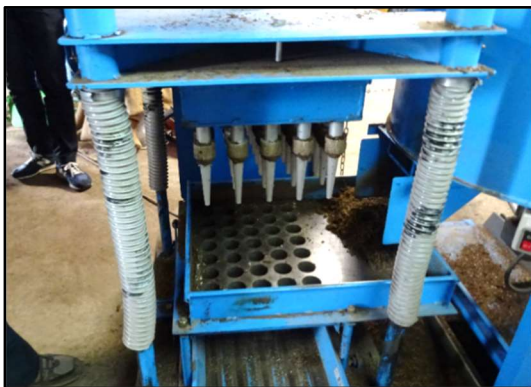
図-4-5 コンテナ苗用培地圧注機 (左：1枚タイプ、右：4枚タイプ)
