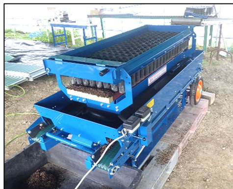
図-4-5 コンテナ苗用培地圧注機 (左：1枚タイプ、右：4枚タイプ)
