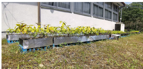
図-1 アルミシート被覆によるコンテナ昇温抑制試験
