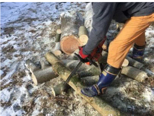
伐倒した木を搬出し、玉切り。
