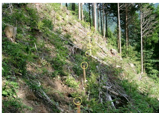
図-8 光量子センサー設置状況(20m伐区)
