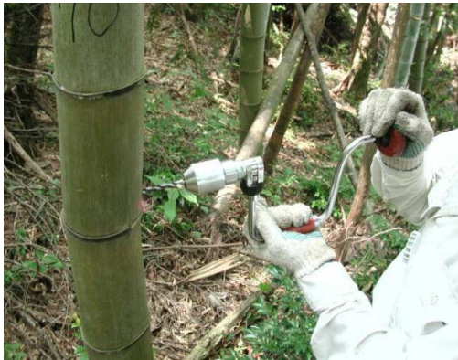
図-28 手動ドリルによる孔開け（120cm部）
