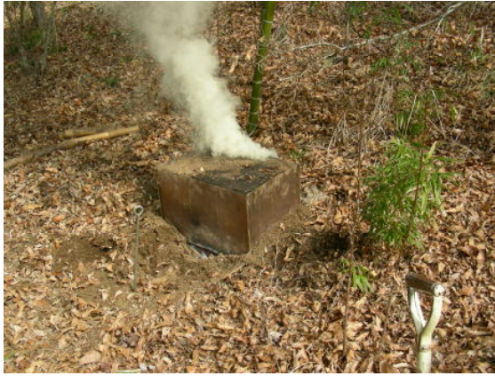
図－43 竹林内地下茎加熱試験 注：簡易軽量炭化炉による加熱
