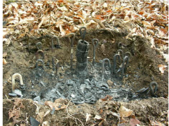
図－44 竹林内地下茎加熱試験 注：切り株及び地面に突き刺した鉄杭
