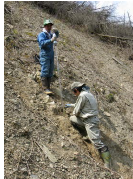
図二 崩壊地における簡易貫入試験の様子
