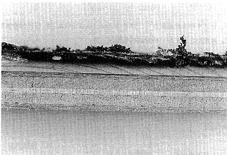
写真1 燃焼試験による炭化層の断面
