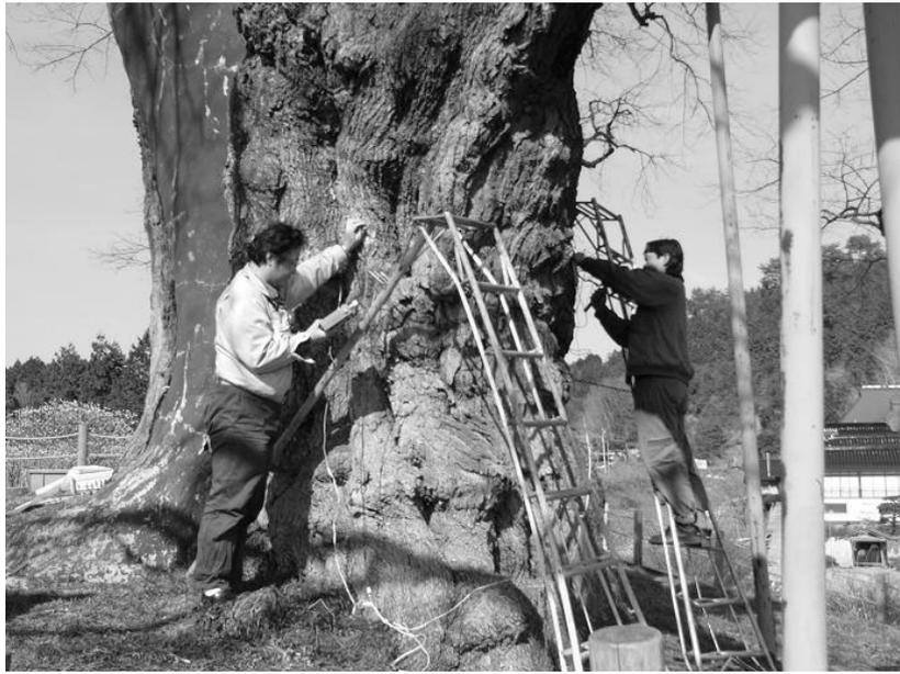
第5図 弾性波が伝わる速さの測定風景
