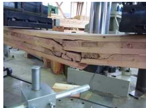
(CLTの面外曲げ試験)
