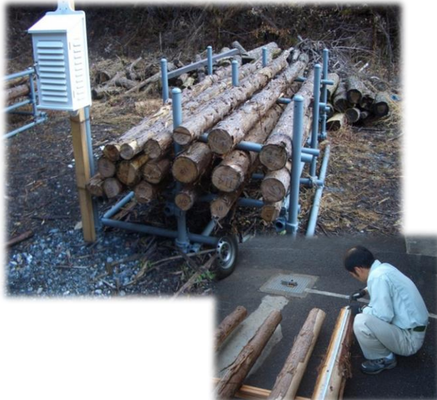
バイオマス利用を進める間伐材の含水率変化調査
