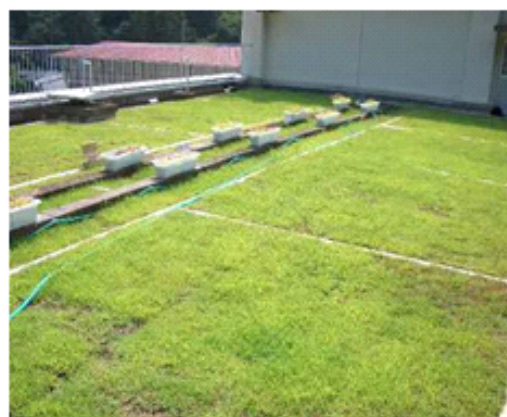
写真2 樹皮シートによる屋上緑化実証試験
