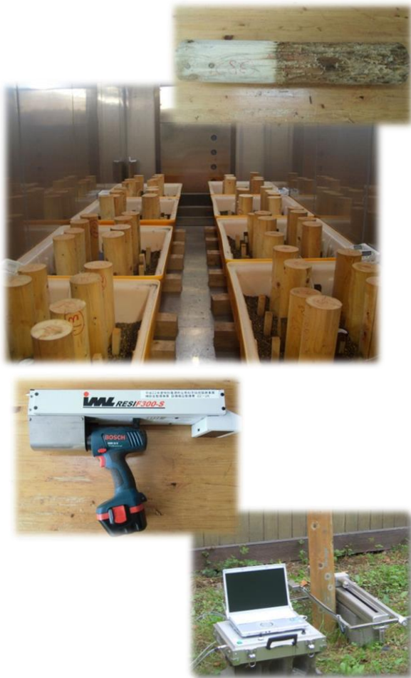
穿孔抵抗測定機(上), ガンマ線測定器(下) による腐朽調査
