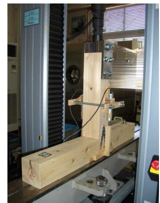
柱脚・柱頭接合部試験
