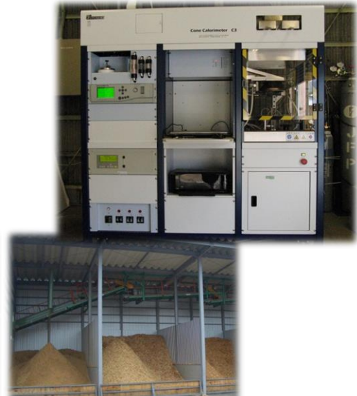
コーンカロリーメータによる 燃焼特性調査
