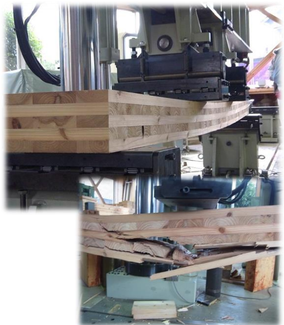
CLTパネルの曲げ試験
