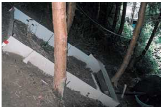
図－1 傾斜ライシメータによる測定
