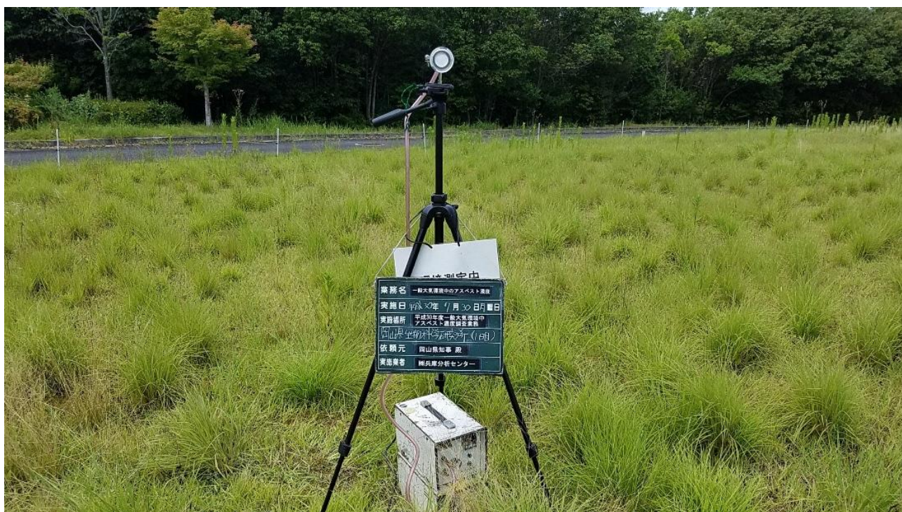
《一般環境中のアスベスト測定の様子》
