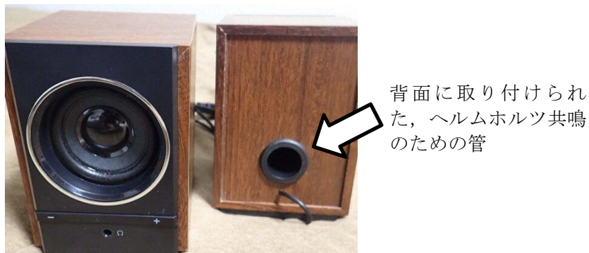
図2-7 ヘルムホルツ共鳴を応用したスピーカーの例
