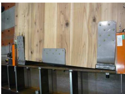
写真 3.1.1 実験 1 (矩形パネル) の脚部の変形状況
