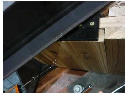
写真 3.3.2 実験 3 の破壊状況
