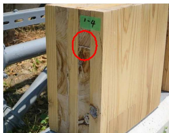
図 12 側端面にも見られる幅はぎ部の隙間
