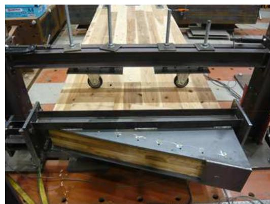
写真 2.1.2 実験 1 (台形壁) の加力治具
