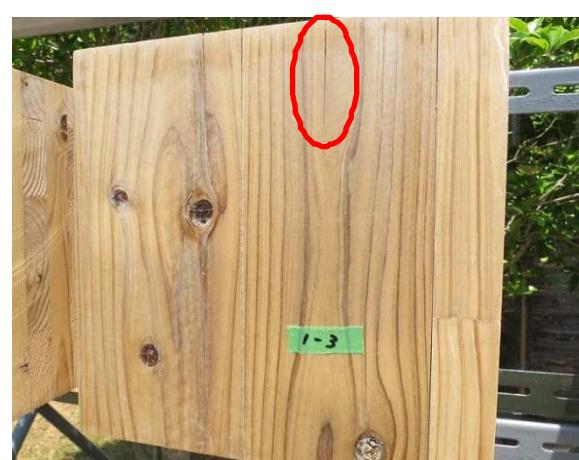
図 14 材端面から材表面への割れ進展
