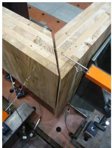
写真 3.5.3 実験 5 の破壊状況
