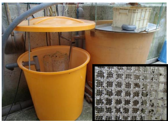
簡易なリン回収装置と金網に付着した MAP
