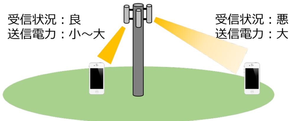
図 35 携帯電話の受信状況と送信電力
