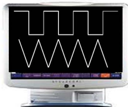
上段:矩形波の例 下段:ノコギリ波の例
