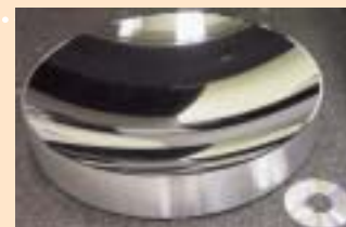
590mmアルミ製凹面ミラー
